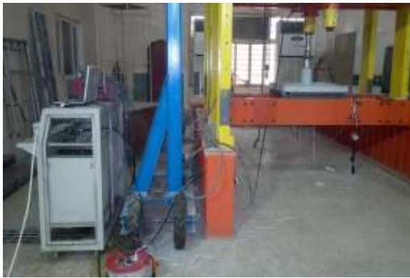
الشكل (4) البلاطة في جهاز الفحص
