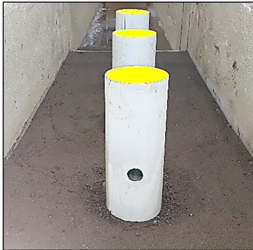
الشكل (2) نموذج للدعامة المستخدمة بقطر 16سم
