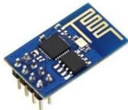
Figure (9) WIFI Module (ESP8266)
