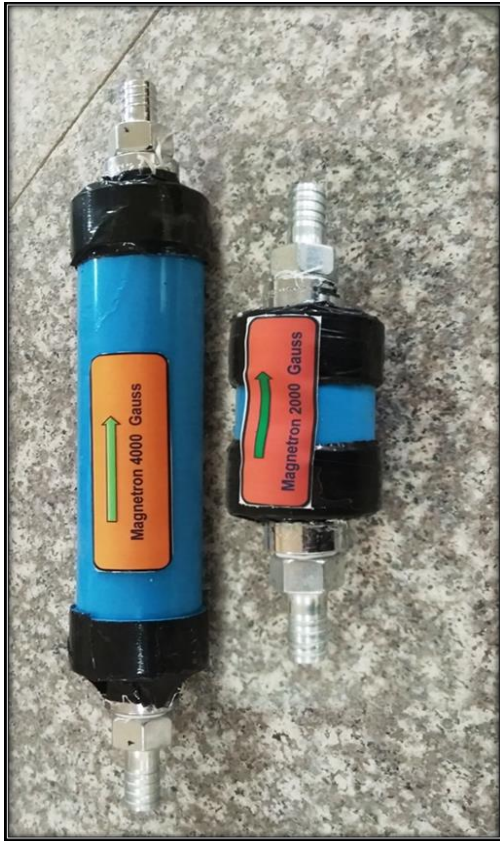
الشكل (3): أجهزة المغنطة بالشكل النهائي
