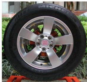
الشكل 2. نموذج هندسي لمحرك معاوق مفتاحي داخل عجلة مركبة كهربائية [27].
