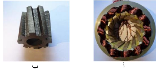
الشكل 19. هيكل محرك منحرف (أ- انحراف الثابت ب- انحراف الدوار) [30].
