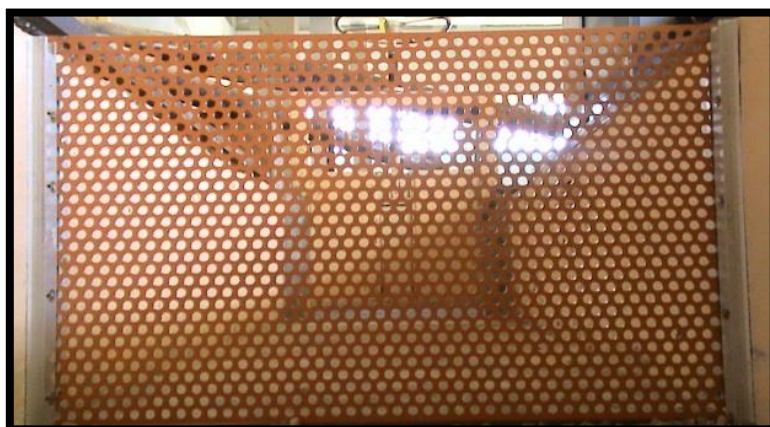
الشكل (2): الجدار المنخلي المستخدم في التجارب بقطر (0.8 وسمك 0.4) سم
