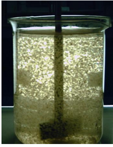
الشكل (9): صور توضح تكون اللبادات بعد مرور 5 دقائق من المزج البطيء باستخدام أ- الشب لوحده ب- الشب مع البولي الكتروليت ج- الشب مع قشور الجوز
