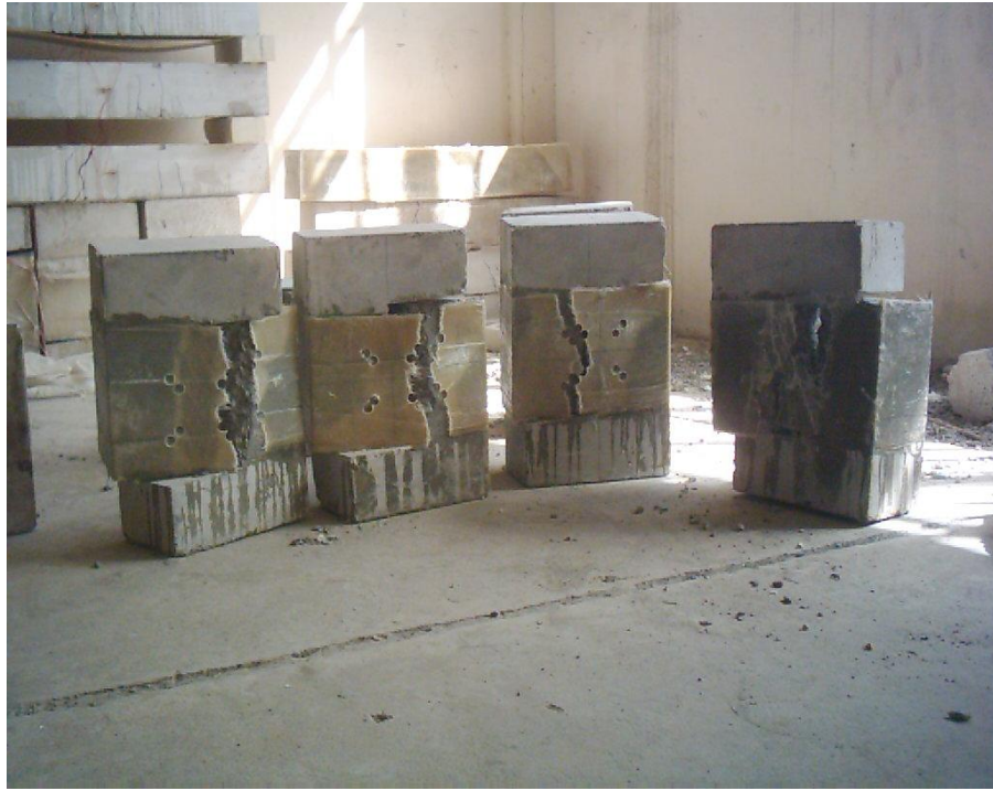
الشكل(12): شكل الفشل للنماذج المغلفة
