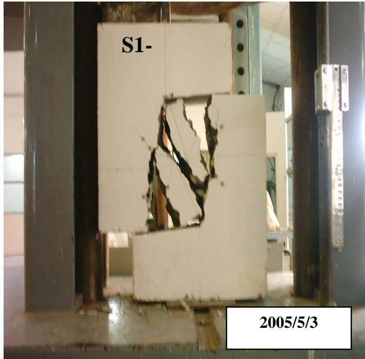
الشكل (11): نموذج فحص القص (S1-0) بعد الفشل
