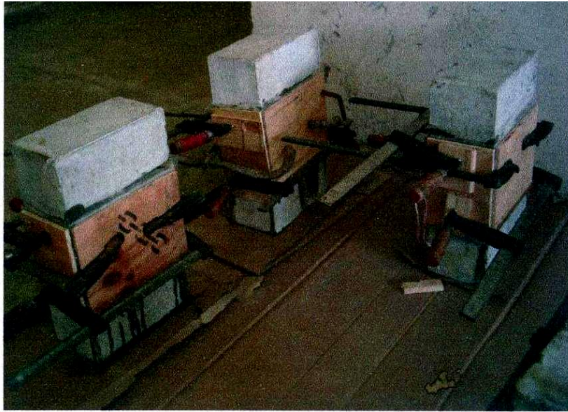
الشكل(3): نماذج فحص القص أثناء فترة التثبيت
