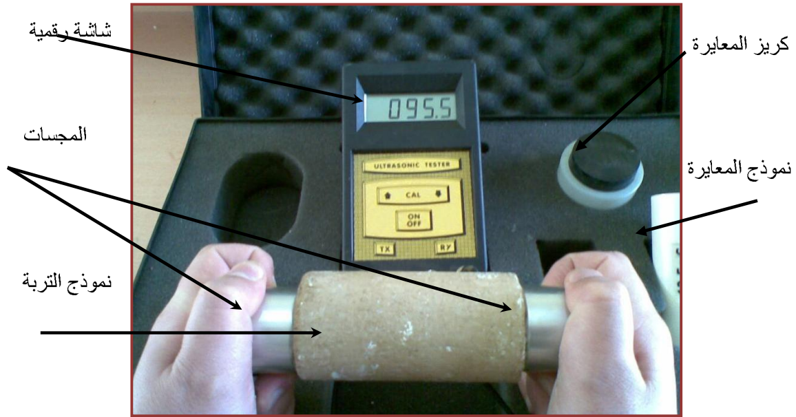
شكل رقم (1): صورة لجهاز فحص سرعة انتقال الموجات فوق الصوتية مع نموذج تربة.
