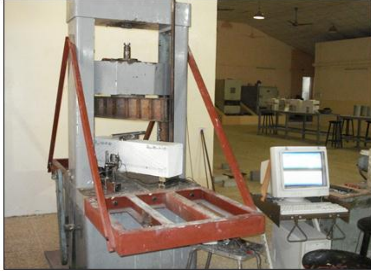
الشكل (4): يوضح طريقة الفحص للعتبات الخرسانية
