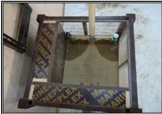
الشكل (2): الحاوية الحديدية للتربة وتجهيز الماء من خلال منقط أو منقطين.
