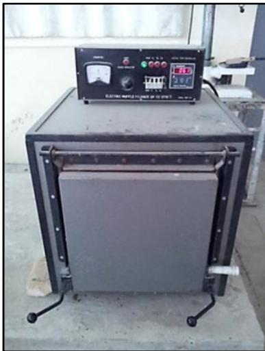
الشكل (6): الفرن الكهربائي المستخدم لإكمال عملية البلمرة.
