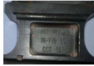
شكل رقم (1) يوضح اسم السبيكة للريشة الحقيقية IN-738
