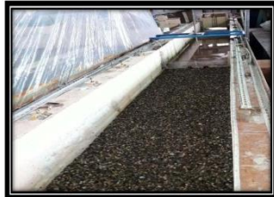
اللوحة (1) طريقة فرش الحصى المكسر مؤخره الهدار
