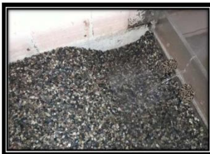
اللوحة (2) هدار ذو فتحة واحدة (d/c=0.115) و (Q=40l/sec) و (h/p=0.25)
