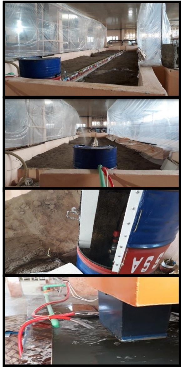
الشكل(3): الخزان الاسطوانى وعلب تجميع الماء على امتداد نصف قطر الإبتلال ومنظومة تجهيز الماء.
